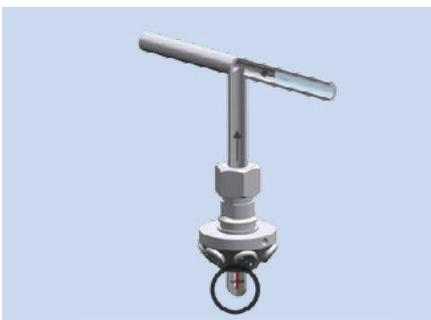
Questo meccanismo può anche essere installato con UGELLI CHIUSI, in nel qual caso diventa un SISTEMA DI PREAZIONE. Il tubo è pieno con acqua dopo la rivelazione incendio, ma l'ugello scarica solo quando la temperatura aumenta (come conseguenza del fuoco) e il la lampadina sensibile al calore dell'ugello spray si rompe. Questo evita falsi allarmi e l'acqua nebulizzata viene scaricata solo in l'area colpita dal fuoco.
