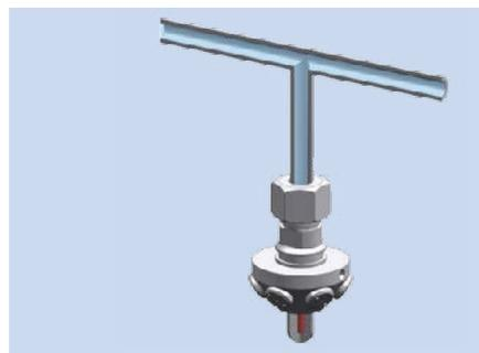
Nei SISTEMI DI TUBAZIONE UMIDITARI, le tubazioni sono sempre cariche di acqua pressurizzata presso pressione pilota, che viene scaricata quando si rompe la lampadina sensibile al calore.
