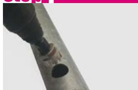
Verificare che la guarnizione sia compatibile per il servizio desiderato. Applicare un velo di lubrificante specifico sulla parte esterna e sulle labbra di chiusura della guarnizione. Applicarne un poco anche sulla superficie interna della guarnizione.
