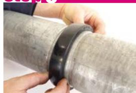
Appoggiare l'estremità della seconda tubazione alla prima e far scorrere la guarnizione sino a che non si trovi appoggiata su entrambe le tubazioni; centrare la guarnizione tra le due scanalature sull'estremità dei 2 tubi.
