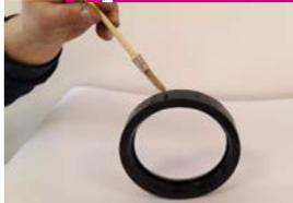
Verificare che la guarnizione sia compatibile per il servizio desiderato. Applicare un velo di lubrificante specifico sulla parte esterna e sulle labbra di chiusura della guarnizione. Applicarne un poco anche sulla superficie interna della guarnizione.
